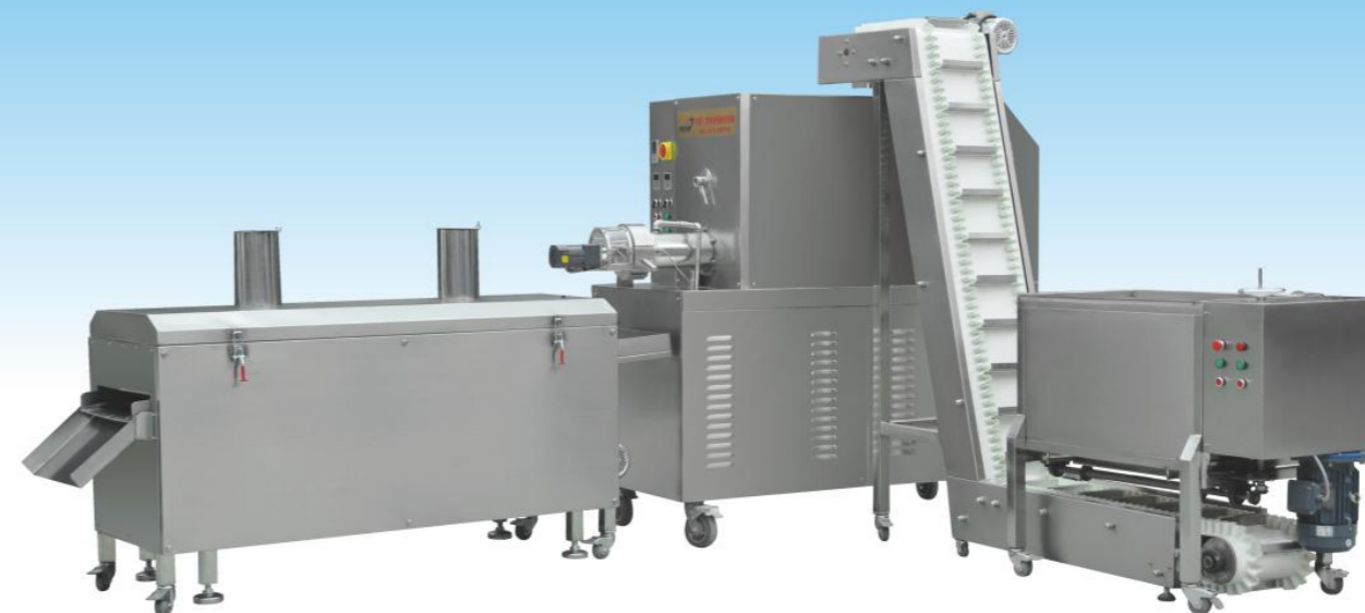
TXF85-S 通心粉挤压机组 Macaroni Extrusion Unit
