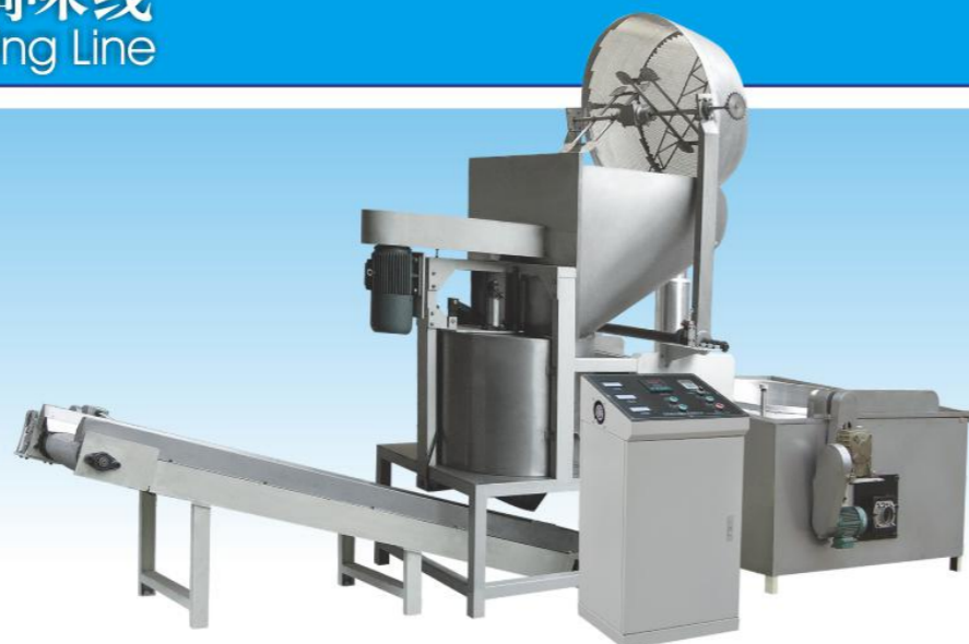
ZYG-D 自动油炸机 Automatic Fryer
